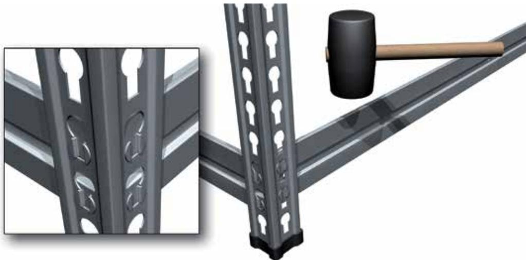
4. Соединить продольные балки между собой с помощью стяжки, для чего вставить язычок стяжки в проушину балки и затем загнуть его на 180 градусов.
